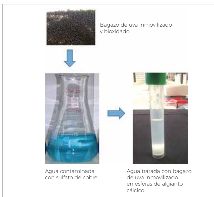
Figura 2. Aspecto del agua contaminada con sulfato de cobre y tratada con bagazo de uva inmovilizado en esferas de alginato cálcico.
