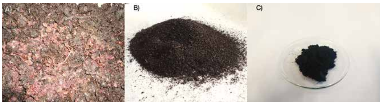
Figura 1. A) bagazo de uva procedente de una bodega. B) bagazo de uva sometido a oxidación biológica. C) carbón activo.
