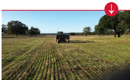
Figura 19. Sementeira realizada com pressão excessiva do semeador sobre o terreno. As depressões visíveis na imagem, foram provocados pelos aros controlados de profundidade.
