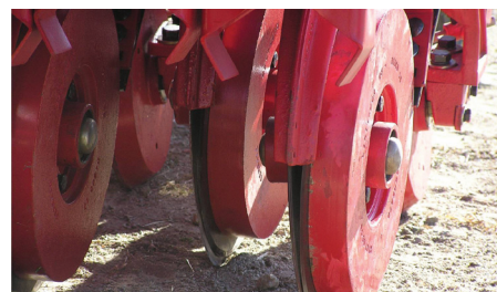
Figura 13. Discos novos em que é bem visível a diferença de diâmetro. Esta diferença é fundamental para garantir o corte de resíduos, pois o disco maior prende os resíduos contra o solo, enquanto o disco menor completa o trabalho de corte.
