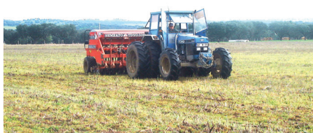
Figura 20. Trator equipado com rodado duplo, de forma a reduzir a compactação do solo durante a sementeira.
