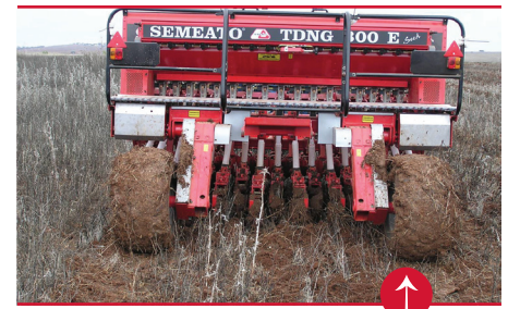
Figura 8. Realização de uma sementeira direta com um teor excessivo de humidade no solo, com a consequente compactação do solo na zona dos rodados, causando ainda irregularidades na superfície do terreno que dificultam as sementeiras em anos posteriores.
