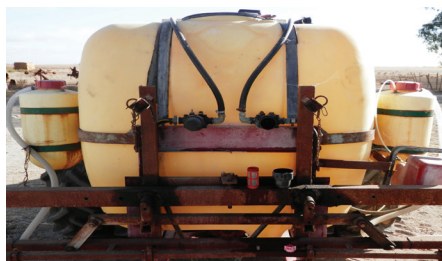
Figura 4. Filtro de linha a incorporar em cada sector da barra, de forma a evitar entupimentos na aplicação de herbicidas a baixo volume (inferior a 100 l/ha). O filtro da direita está desmontado de forma a ver-se o seu interior.
