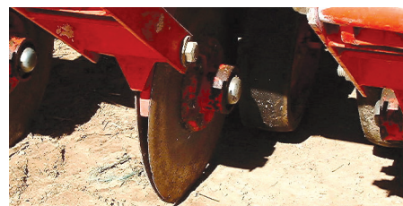
Figura 14. Discos muito desgastados, apresentando os dois o mesmo diâmetro. Neste caso os dois discos atuam em simultâneo, pelo que os resíduos são empurrados para o fundo do sulco, onde é depositada a semente.
