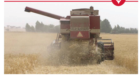
Figura 15. Colheita de um trigo em que a palha vai ser deixada no terreno. O seu espalhamento, assim como das moinhas, é fundamental para garantir o sucesso da sementeira da cultura seguinte.
