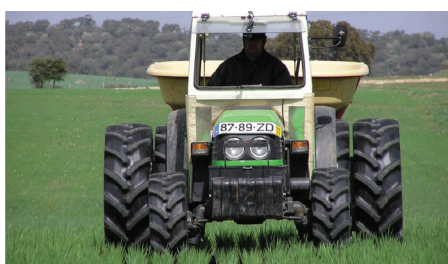
Figura 21. Trator equipado com rodado duplo e com potência ajustada à operação, de forma a impedir a compactação do solo na operação de distribuição de azoto em cobertura, numa cultura de trigo.
