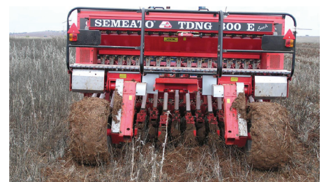
Figura 18. Sementeira directa com teor de humidade do solo elevado. No entanto, o semeador vai bem regulado, não se notando na superfície do terreno as marcas dos aros controladores de profundidade.
